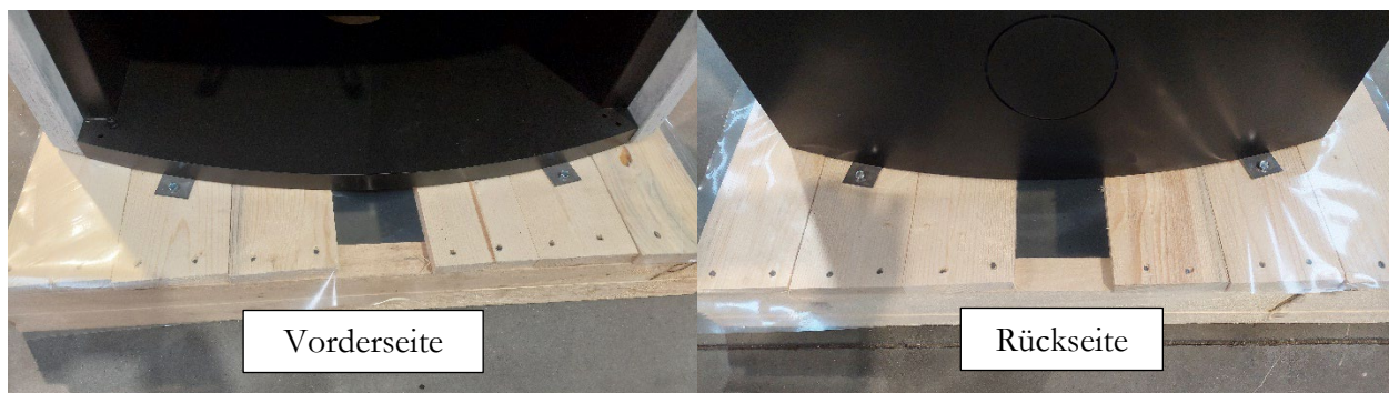
Abbildung 4 Streben, die den Ofen an der Basis befestigen und ebenfalls gelöst werden müssen.
