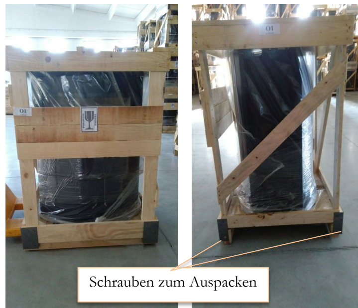
Abbildung 3 Darstellung der Schrauben, die zum Lösen des Rahmens gelöst werden müssen.
