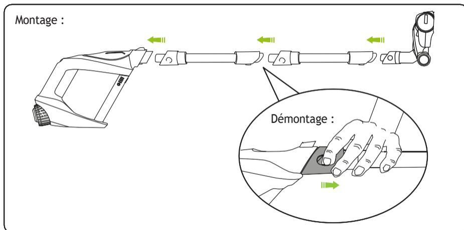
Pour utiliser le produit en mode nettoyage de sol, joignez les 2 sections du tube d'extension et montez la tête de nettoyage de sol à l'extrémité. Assurez-vous que toutes les pièces sont correctement alignées et mettez-les en place. Assurez-vous que le produit est éteint avant de retirer ou d'installer des accessoires.
