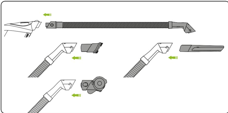
Le tuyau flexible se fixe de la même manière que les autres accessoires et peut être utilisé tel quel ou avec l'ajout d'autres outils. Les unités motorisées peuvent s'adapter directement au tuyau flexible.
