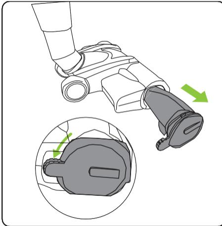
Avant de retirer la barre de brosse, vous devez retirer la tête de plancher motorisée du tube d'extension. Tournez le loquet situé sur le côté de la tête de plancher motorisée en position "déverrouillée" et retirez la barre de brosse.
