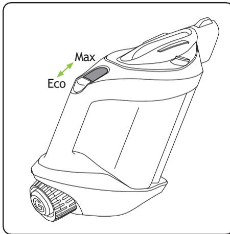
Le produit dispose de 2 réglages de puissance : Le mode Max (puissance d'aspiration plus élevée et durée de fonctionnement plus courte) et le mode Eco (puissance d'aspiration plus faible et durée de fonctionnement plus longue). Changez de mode en faisant glisser l'interrupteur situé devant le bouton On/Off. Le produit se mettra en marche dans le mode qu'il a utilisé en dernier.
