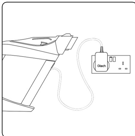
Branchez le chargeur et connectez-le au port de charge situé sur le côté de la batterie.
