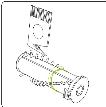
Pour retirer les poils de la barre de brosse, faites passer l'outil d'épilation dans la rainure pour couper les poils, puis retirez-les. N'utilisez jamais le bloc moteur sans la barre de brosse.
