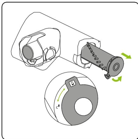
Pour nettoyer la barre de brosses, retirez d'abord la brosse électrique. Faites pivoter le loquet de la position "verrouillage" à la position "déverrouillage" et retirez la barre de brosse.
