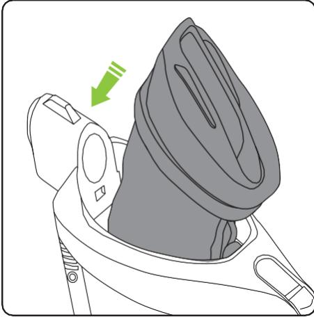
Une fois le sac fixé et redressé, replacez le couvercle sur le corps principal, en vous assurant que le bouchon du sac est également inséré.
