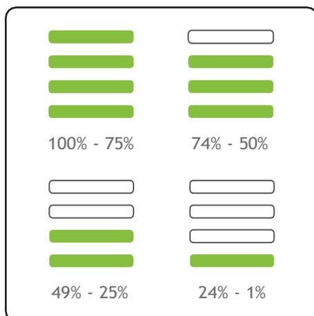
Le témoin d'état de charge de la batterie indique le niveau de charge du produit. Au fur et à mesure que vous utilisez le produit, les voyants verts s'éteignent dans le sens de la descente.
