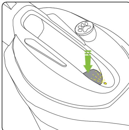
Une lumière au-dessus de la fenêtre sur le haut du couvercle permet une visibilité dans le sac pour indiquer quand le sac est plein ou s'il y a un blocage.
