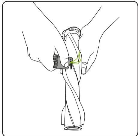
Pour retirer les poils de la barre de brosse, utilisez l'outil d'épilation pour couper les poils avant de les retirer. N'utilisez jamais le balai mécanique sans que la barre de brosse soit en place.
