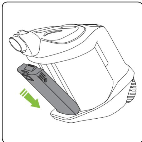
Pour remplacer la batterie, insérez-la à l'avant du produit en commençant par le bas, le loquet étant tourné vers l'extérieur.
