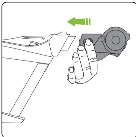
Um die Elektrobürste anzubringen, stecken Sie sie über die Standarddüse. Der Strom muss während des Düsenwechsels ausgeschaltet sein. Mit der Einschalttaste werden nun sowohl die Bürste als auch die Saugleistung eingeschaltet.
