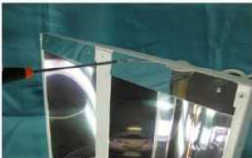
2. SVITARE LE QUATTRO (4) VITI CHE BLOCCANO LE TESTATE LATERALI DELLA PARABOLA E TOGLIERLE
