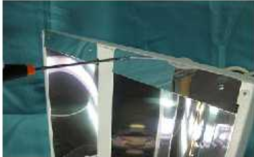
2. AFLOJAR LOS CUATRO (4) TORNILLOS QUE BLOQUEAN LOS CABEZALES LATERALES DE LA PAROTIDA Y QUITARIOS.
