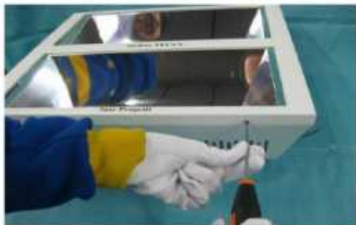
1. DEVISSER LES VIS QUI FIXENT L'ENCADREMENT
