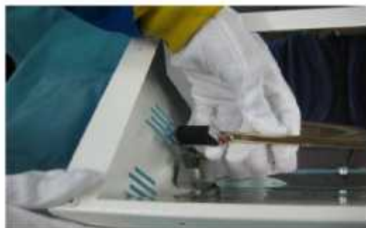
3. DEBLOQUER DES RESSORTS DE TENUE LES JOINTS SILICONIQUES QUI RECOUVRENT LES DEUX EXTREMITES DE L'AMPOULE
