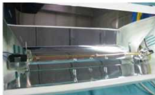
7. REINSERER LES JOINTS SILICONIQUES DANS LES DEUX RESSORTS COMME EN ORIGINE
