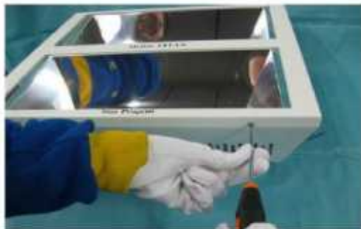
1. SVITARE LE VITI CHE TRATTENGONO LA CORNICE
