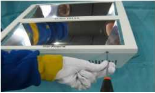
1. DIE ZWEI BEFESTIGUNGSSCHRAUBEN DES RAHMENS LÖSEN.
