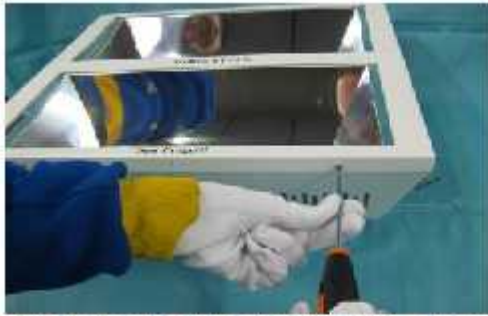
1. AFLOJAR LOS TORNILLOS QUE SUIFTAN EL MARCO
