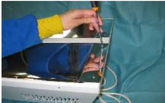
2. ОТКРУТИТЕ 4 ВИНТА, КРЕПЯЩИХ БОКОВЫЕ ЧАСТИ ПАРАБОЛЫ РЕФЛЕКТОРА И СНИМИТЕ ИХ.
