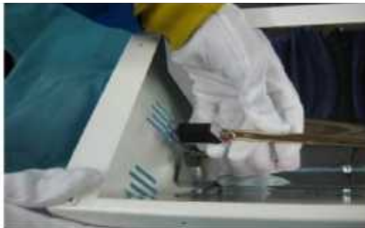
3. DIE SILIKONDICHTUNGEN AN DEN BEIDEN ENDEN DER LAMPE AUS DEN FEDERN LÖSEN.
