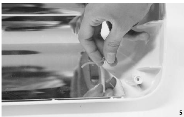
5. ENFILER LES PROTECTIONS THERMO-ÉLASTIQUES DE RECHANGE À LA PLACE DE CELLES QUI ONT ÉTÉ RETIRÉES, DÉNUDER LES FILS SUR 5/6 MM. ENFILER LES NOUVELLES COSSES (FASTON) DE RECHANGE ET LES SERTIR SUR LA PARTIE DÉNUDÉE DES FILS. NE PAS TOUCHER L'AMPOULE À MAINS NUES.
