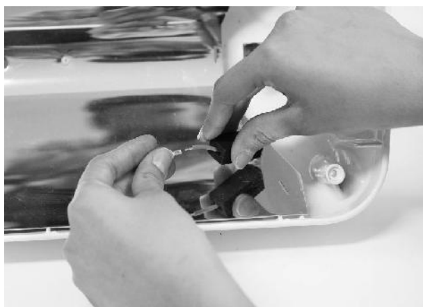
6. COLLEGARE I FASTON MASCHI DEL NUOVO BULBO A QUELLI DEI DUE CAVI, RIVESTIRLI CON LE CAPSULE ELASTOTERMICHE E RIPOSIZIONARE IL BULBO NELLA SEDE DELLE MOLLETTE
