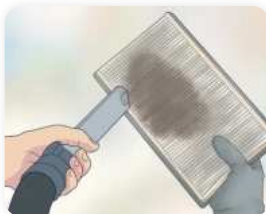
Pulire il filtro con un aspirapolvere o acqua corrente
