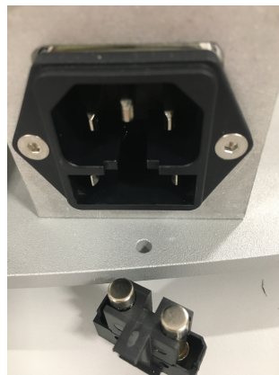
Figure 2: Procedura di sostituzione del fusibile
