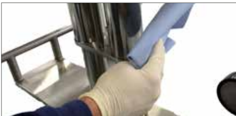
Abb. 8.3.2.A: Hubsäule von Abrieb befreien
