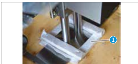
Abb. 5.2.2.D: Holzleisten (Befestigung des Operationstisches an der Palette)
