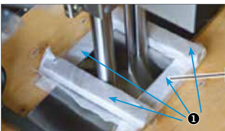
Abb. 5.2.2.D: Holzleisten (Befestigung des Operationstisches an der Palette)
