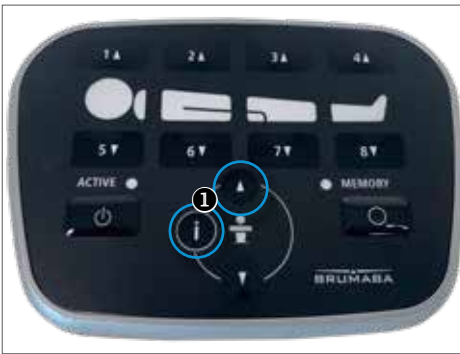
Abb. 6.10.A: Tastenkombination zur Anzeige der Akkuspannung (1)
