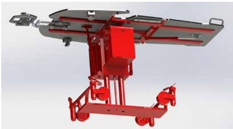
Abb. 2.5.2.D: Leitfähige Teile der Konstruktion
