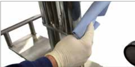
Abb. 8.3.2.A: Hubsäule von Abrieb befreien
