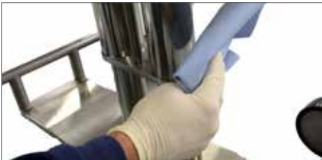
Abb. 8.3.2.A: Hubsäule von Abrieb befreien
