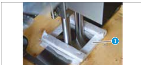
Abb. 5.2.2.D: Holzleisten (Befestigung des Operationstisches an der Palette)
