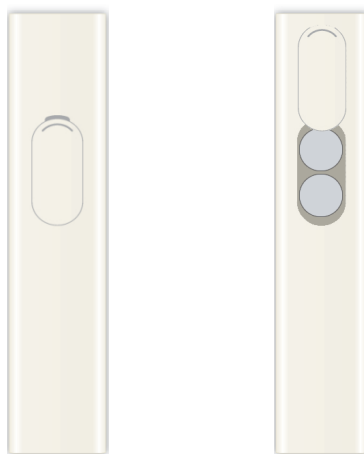
Figura 55: Manutenzione delle batterie del telecomando serie CC
